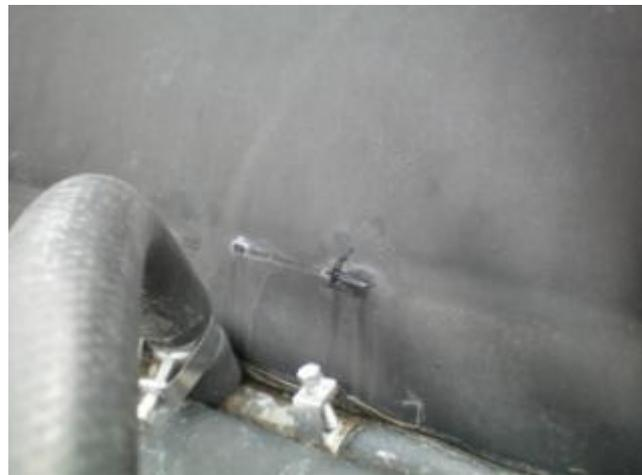
**Abbildung 107:** Unfachmännisch platzierter Gassack (links) und Risse im Folienspeicher (rechts)
