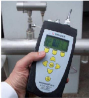
**Abbildung 5:** COMBIMASS<sup>®</sup> GA-M der Firma *Binder* (Binder Combimass<sup>®</sup> GA-m 2009)
