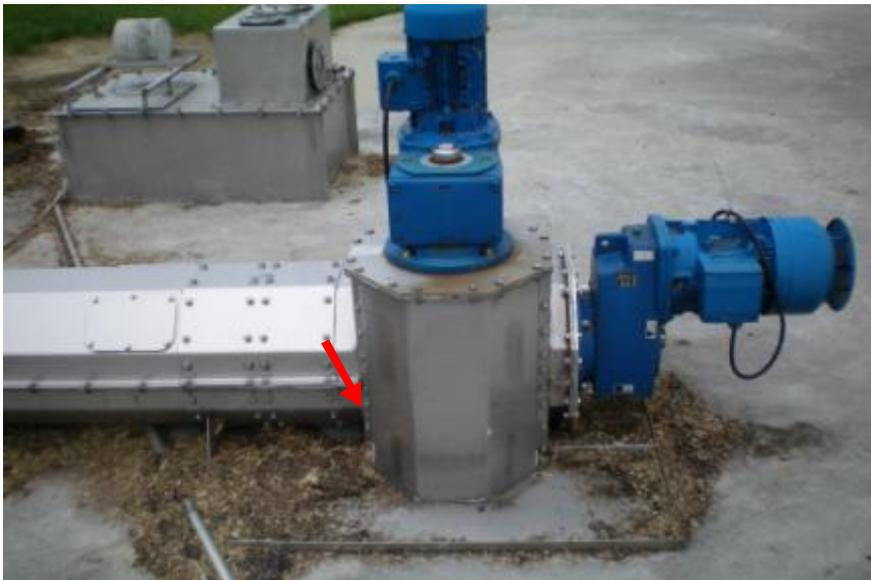
**Abbildung 111:** Methanemissionsquelle am Deckendurchgang einer Förderschnecke von BY7
