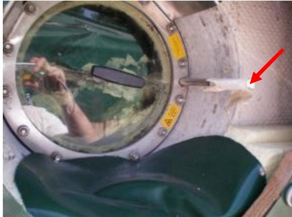
**Abbildung 106:** Unsachgemäß ausgeführte Installation eines Schauglases
