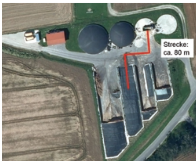
Abbildung 2: Anlagenlayout Anlage A (LVG 2010)
